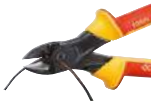
Ближе к шарниру режет струнную проволоку и прочие твердые материалы
